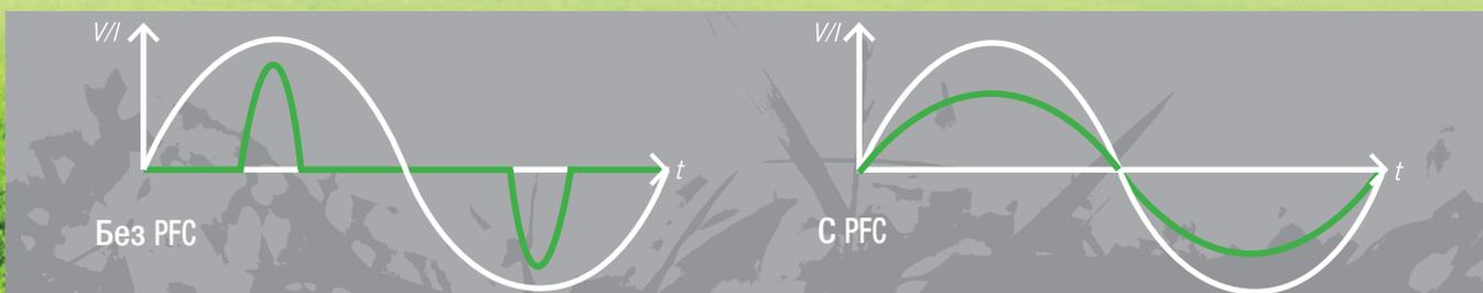
Оператор имеет возможность производить сварку электродом диаметром  $\varnothing 3,25$ , используя кабель удлинителя  $3 \times 2,5$  мм длиной 250 м (напр., сваривать электродом  $\varnothing 2,5$ , используя кабель длиной 500 м). Это становится возможным благодаря уникальной функции PFC, которая регулирует первичный источник питания.
