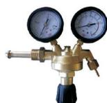
Газовый регулятор, 2 измерительных прибора
